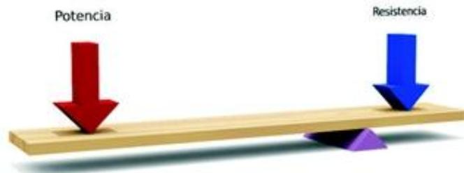
*Palanca de Segunda Clase:* El punto de resistencia se localiza entre el punto de apoyo y el punto de potencia (Destapador de botellas, Cortador de Paja, etc.).
