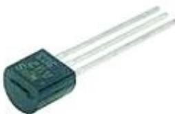
Un **transistor** es un aparato que funciona a base de un dispositivo semiconductor que cuenta con tres terminales, los que son utilizados como amplificador e interruptor. Una pequeña corriente eléctrica, que es aplicada a uno de los terminales, logra controlar la corriente entre los dos terminales.
