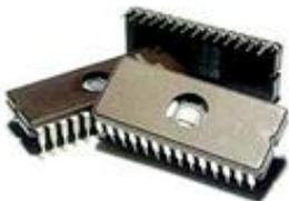
Las conexiones entre los distintos elementos suelen hacerse evaporando películas metálicas sobre el cristal; todos los componentes se fabrican conjuntamente.
