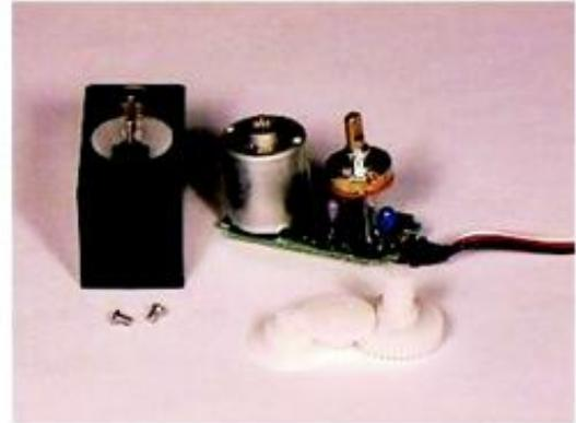
El concepto de servomotor incluye el sistema de manejo del mismo. Esto es, no importa que motor sea, puede ser un servomotor si tiene un sistema de manejo con un algoritmo y un circuito para seguir instrucciones precisas.
